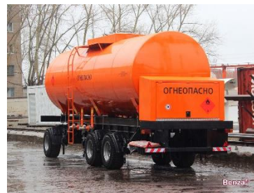
Передвижная АЗС «Прицеп-топливозаправщик» объемом 30 м 3
