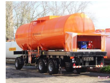
Передвижная АЗС «Прицеп-топливозаправщик» объемом 30 м 3
