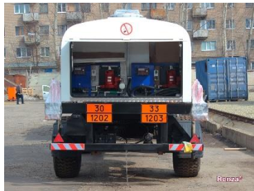
Передвижная АЗС «Прицеп-топливозаправщик» объемом 9,5 м 3
