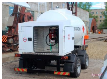
Передвижная АЗС «Прицеп-топливозаправщик» объемом 4 м 3
