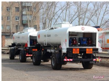
Передвижная АЗС «Прицеп-топливозаправщик» объемом 9,5 м 3
