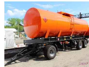
Передвижная АЗС «Прицеп-топливозаправщик» объемом 20 м 3
