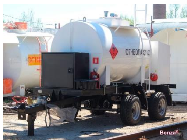
Передвижная АЗС «Прицеп-топливозаправщик» объемом 4 м 3
