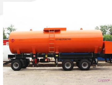
Передвижная АЗС «Прицеп-топливозаправщик» объемом 20 м 3
